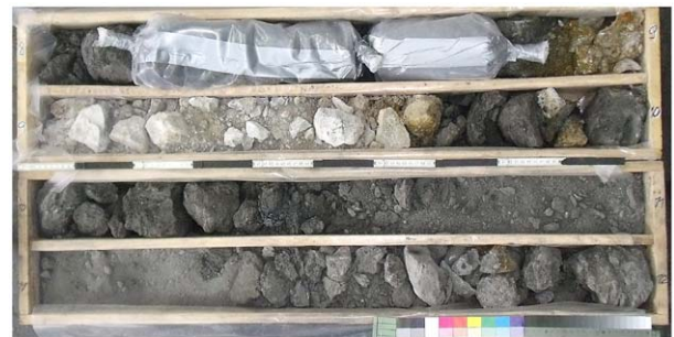
Abb.7: Im geotechnischen Sinn kaum brauchbarer Bohrkern. Kantengerundete Bruchstücke zeugen von rotierenden Klasten im Kernrohr (Trockenkernverfahren).
