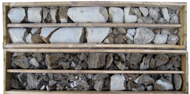
Abb. 8: Durch engständige Klüftung zerlegter Bohrkern
